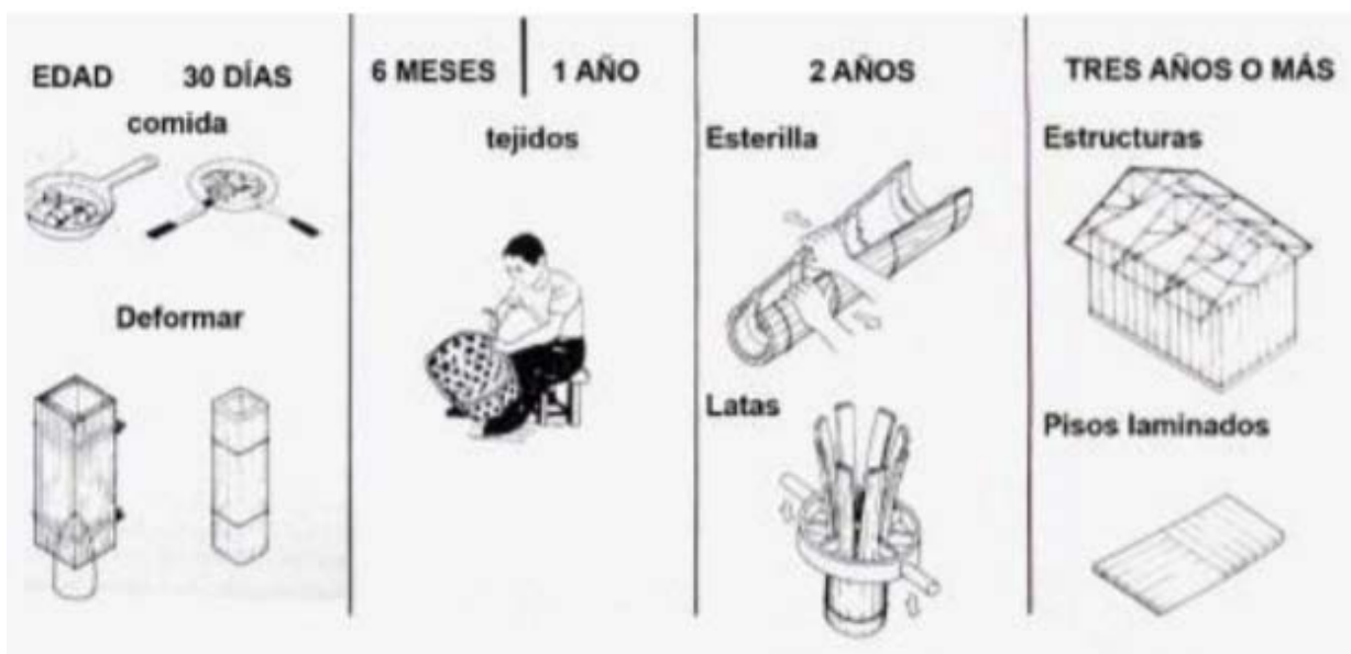
Figura 6: Distintos usos del bambú en crudo dependiendo de la madurez a la que se tala.
