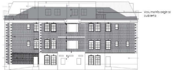
Plano 14. Esquema modificación cubierta FUENTE: Esquema A. Toro sobre levantamiento del Arq. Giovanni Orozco.
