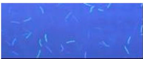
Figura 3. Fibrillas de seguridad a la luz ultravioleta
