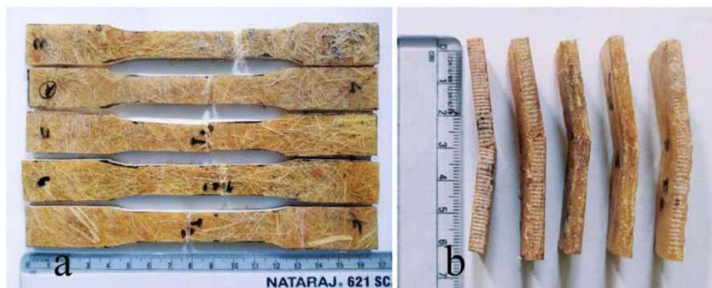
Figura 13. Muestras fracturadas a) muestras de tracción y b) muestras de flexión.
