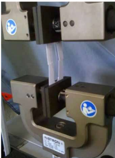
Figura 7. Montaje de las fibras en la máquina de tensión.
