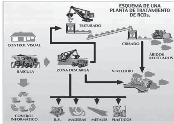
**Figura 3.** Caracterización de los materiales RCD.
