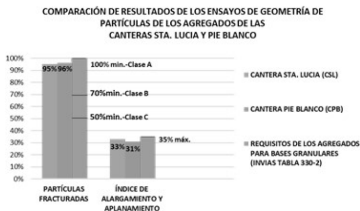
Figura 15. Gráfica de análisis de resultados de los ensayos de partículas fracturadas e índices de alargamiento y aplanamiento. Fuente: Autoría propia.
