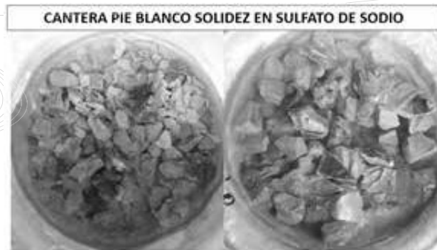
Figura 18. Resistencia de los agregados de la cantera Pie Blanco bajo ataque por sulfato de sodio. Fuente: Autoría propia.
