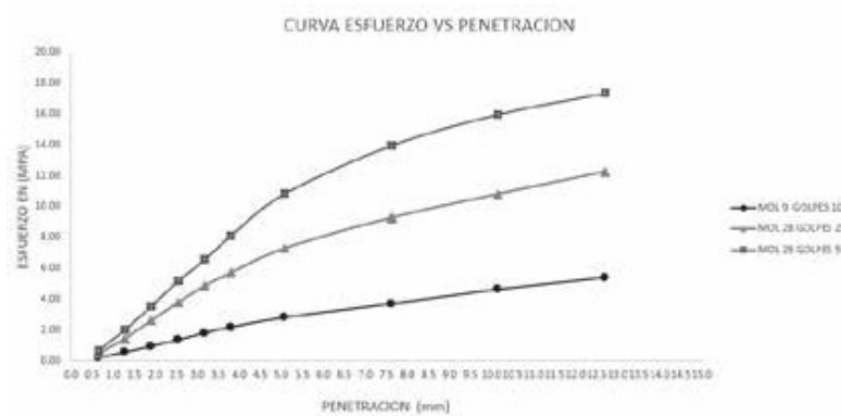
Figura 10. Curva esfuerzo vs penetración con calamina. Fuente: autoría propia
