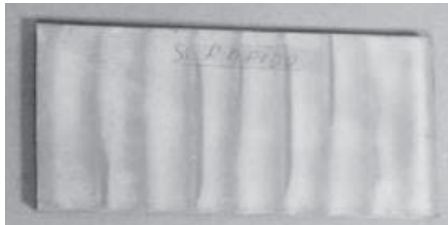
FIGURA 5 VELOS DE HORNO. Fuente. Recuperado de Mejía, S. Origen de las Eflorescencias. 2013.
