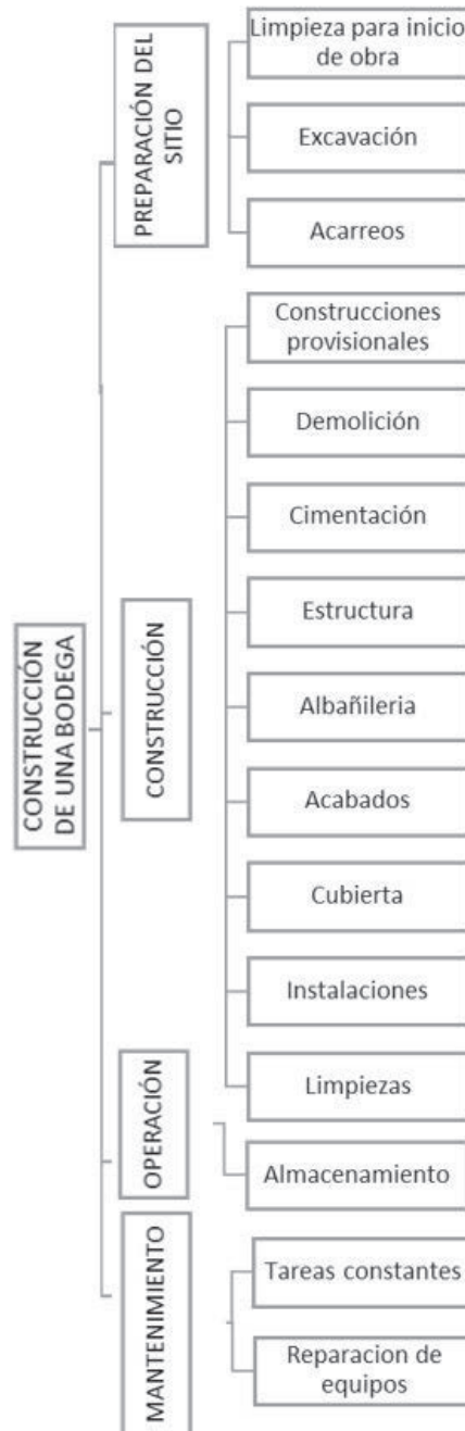
ILUSTRACIÓN 1: FASES DE CONSTRUCCIÓN DE LA BODEGA Fuente:
