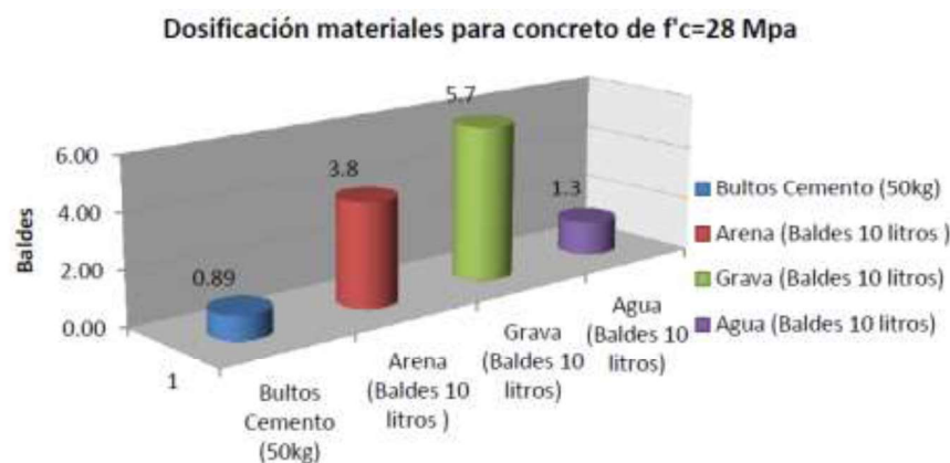
Figura 2: Dosificación usada para f'c = 28 MPA Fuente: Autor
