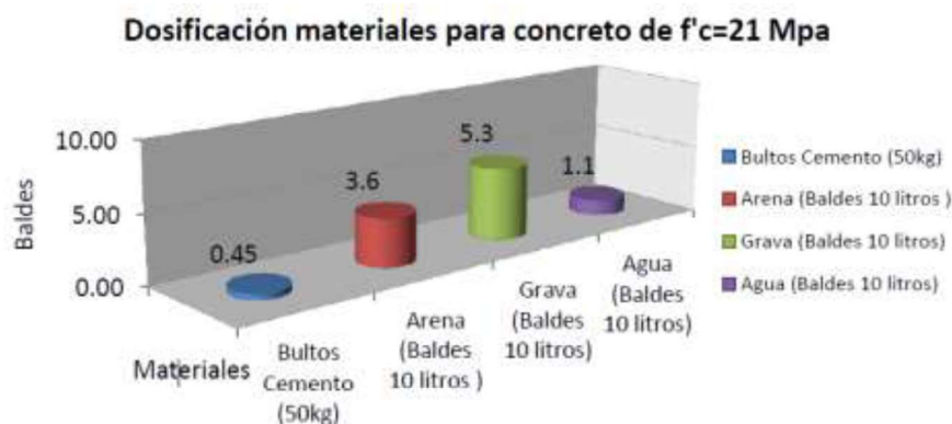
Figura 1: Dosificación usada para f'c = 21 MPA Fuente: Autor
