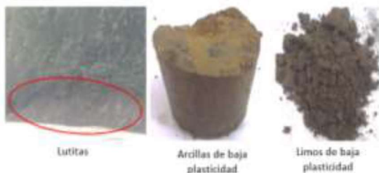
Figura 17. Materiales Presentes en la Zona de Estudio parte Alta Fuente: Servicios de Ingeniería Limitada
