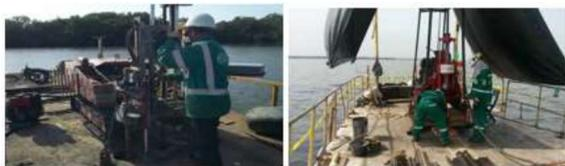
Fotografía 1. Izquierda: Ejecución de exploración CPT. Derecha: Exploración SPT. Fuente: autor
