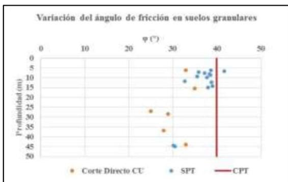
Figura 10. Comparación de valores de ángulo de fricción entre resultados de laboratorio y ensayos de campo. Fuente: Autor
