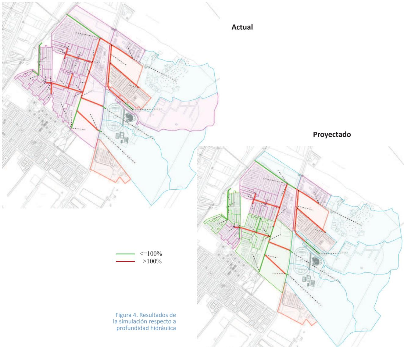
Figura 4. Resultados de la simulación respecto a profundidad hidráulica
