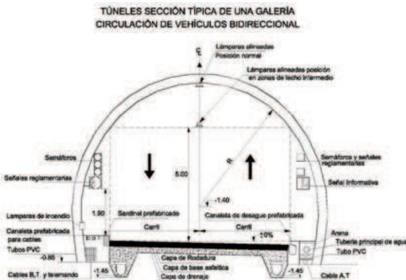
Fig.10. Sección Túnel Sumapaz. Tomada de [8].
