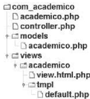
FIGURA 5. ESQUEMA DE LA ESTRUCTURA DE ARCHIVOS UTILIZADAS PARA EL COMPONENTE EN EL FRONTEND
