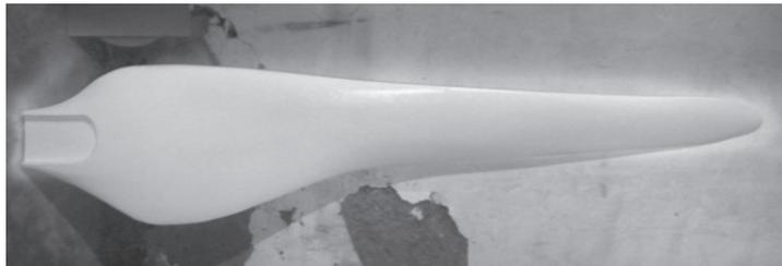
FIGURA 3. Modelo en madera del aspa tipo NACA 4412. Fuente: Los autores.
