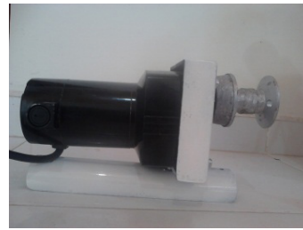
Figura 2. Trinquete y Motor de tensión para la descarga de peso
