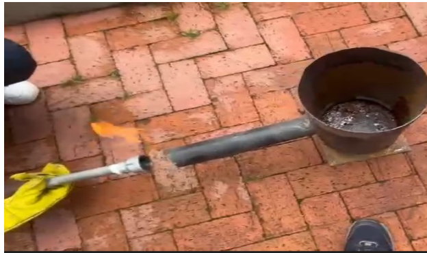
Figura 9. Llama sin entrada de oxígeno. Fuente: Los autores
