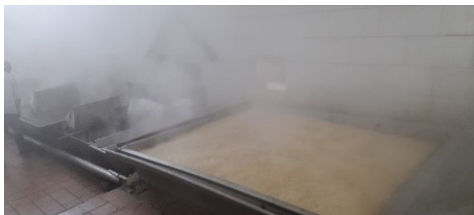
Fig. 7. Segundo fondo, adición de cal Fuente Autores NotaTrapicheElPaneleroS.A. S
