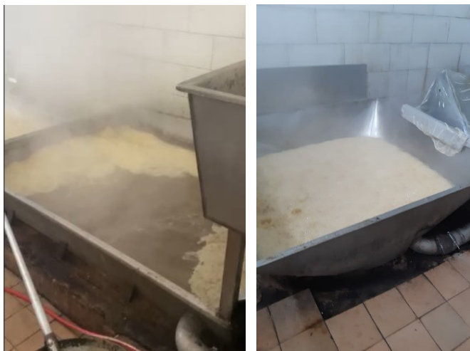
Fig. 5. Primer fondo, proceso de clarificación Fuente Autores NotaTrapicheElPaneleroS.A. S
