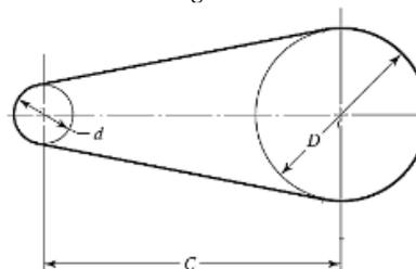
Nota. Sistema de transmisión de potencia por poleas. Diseño de elementos de máquinas de Shigley 8 edición.
