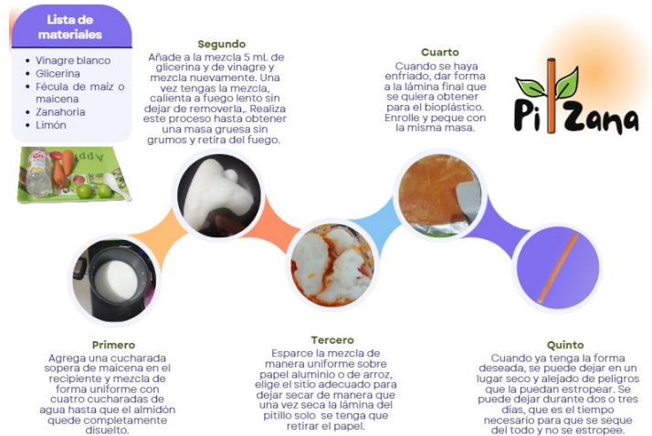
Figura 5. Pasos para la elaboración de un pitillo casero biodegradable a base de la celulosa orgánica de la zanahoria. Fuente: Propia
