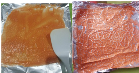
Figura 6. a) Mezcla del pitillo biodegradable. b) Lámina para la realización del pitillo fragmentada
