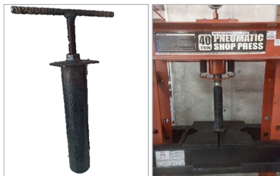
Fig. 7. Moldaje para la elaboración de briquetas Fuente: Autor
