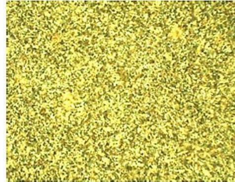
Figura 7 Probeta de acero 1045 a 100X- Sin tratamiento. Fuente: Autores
