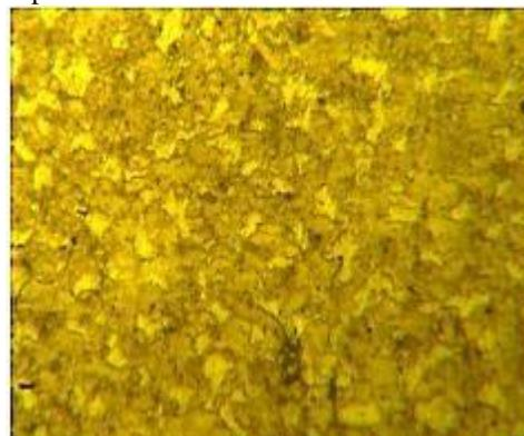
Figura 17 Probeta de acero 8620 a 100X- Normalizada. Fuente: Autores
