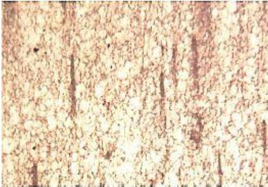
Figura 10 Probeta de acero 1045 a 100X – Temple en aceite. Fuente: Autores
