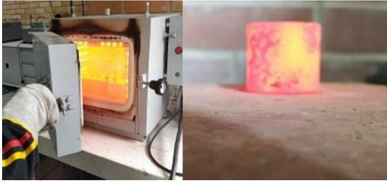
Figura. 5 (a) Probetas de acero en el horno mufla, (b) Probetas calentadas hasta temperatura de austenización completa (950°C). Fuente: Autores
