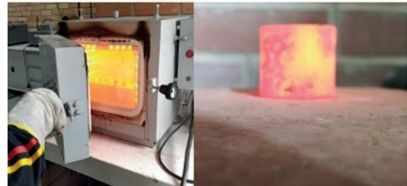
Figura 5. (a) Probetas de acero en el horno mufla, (b) Probetas calentadas hasta temperatura de austenización completa (950°C). Fuente: Autores
