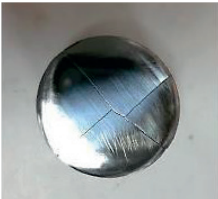
Figura 21. Probeta de acero 8620 fracturada por el temple en agua. Fuente: Autores
