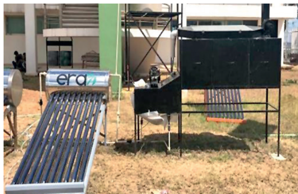
Fig. 2. Secador solar tipo túnel con hibridación de tecnologías solares en operación.
