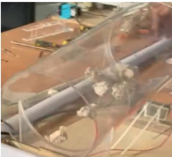
**Fig. 3.** Tubo de acople para la alineación de los residuos.
