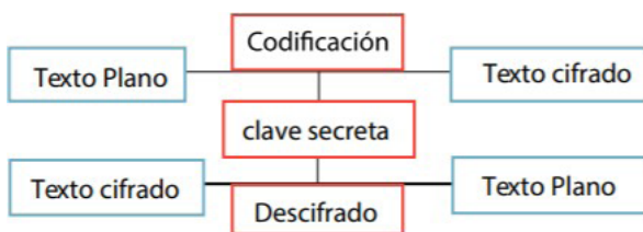
Fig. 2. Proceso de clave para criptografía simétrica
