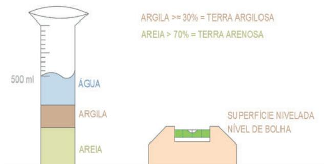
Fig. 1. Ensaio de granulometria por sedimentação
