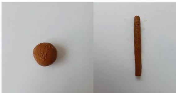
Fig. 2. Teste de plasticidade "Teste da cobrinha"
