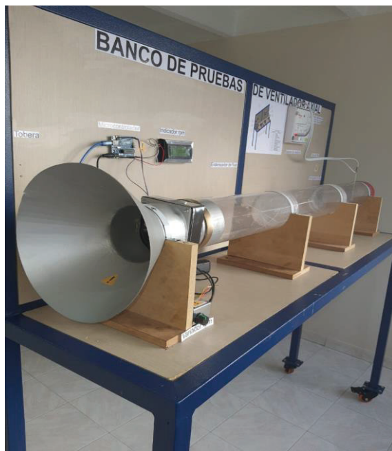
Fig. 17. Vista frontal ensamble final banco de pruebas. Fuente: Autor del proyecto
