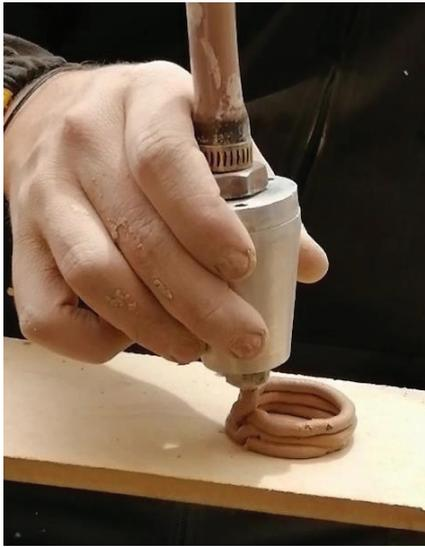
**Figura 9.** Extrusión con motor Nema 23 y movimientos manuales.
