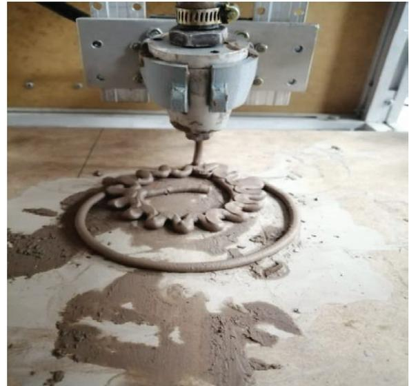
**Figura 11.** Extrusión y movimientos con motor Nema 23
