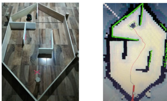
Fig. 6. Resultado de la prueba 5 aplicando el algoritmo A-star(A*) junto con Dijkstra con obstáculos. Fuente. Autores.
