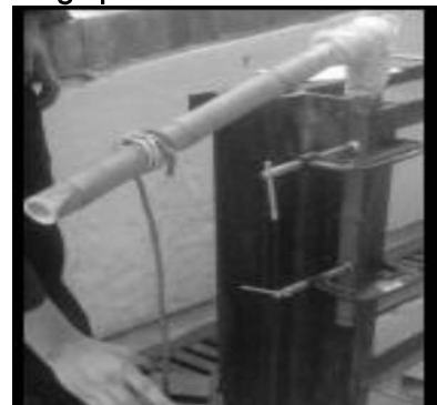
Fig.8: Carga para unión en L
