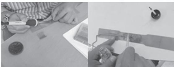
**Figura 3.** Soldadura de los terminales y recubrimiento de la galga,
