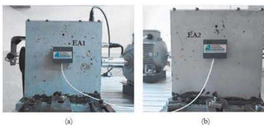
**Figura 14.** Ubicación del sensor EA en la caja de engranajes: (a) lado lateral izquierdo sensor EA1, (b) lado lateral derecho sensor EA2
