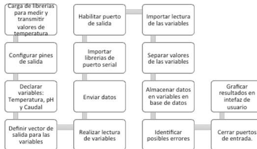
Figura 9. Diagrama de flujo para las etapas de la lectura, transmisión y graficación de los datos adquiridos por los sensores
