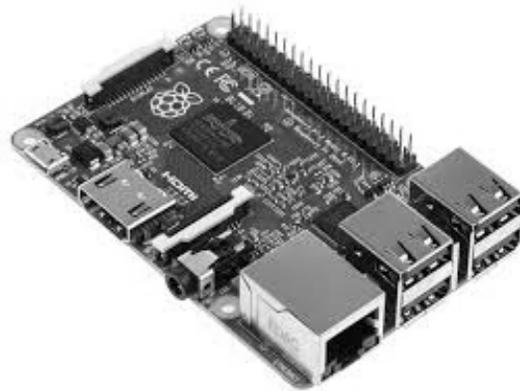
Figura 5. Tarjeta Raspberry Pi 2 utilizada para la comunicación y transmisión de los datos
