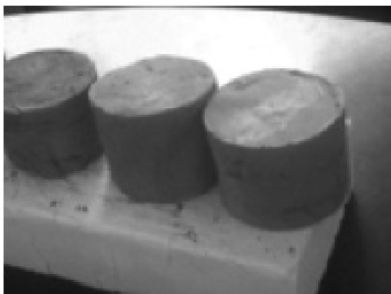
Figura 1. Material sinterizado sometido a una temperatura de 1000 °C
