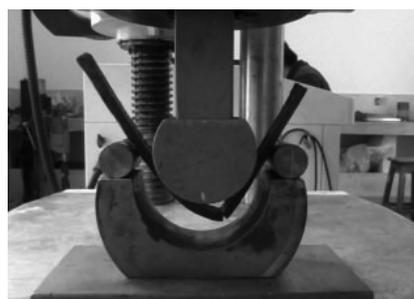
Figura 4. Ensayo de resistencia a la flexión
