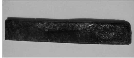
Figura 2b. Probeta de material compuesto para ensayo de flexión, según norma ASTM D790-10
