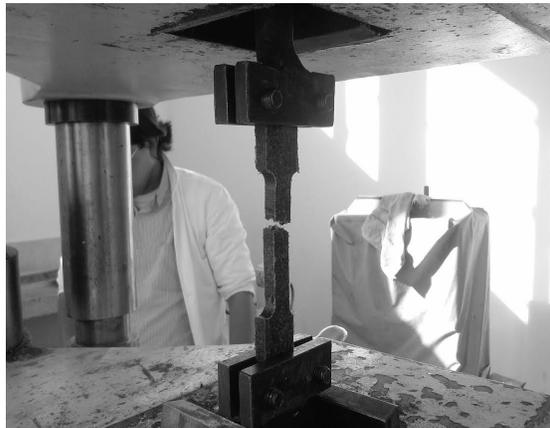
Figura 3. Ensayo de resistencia a la tracción
