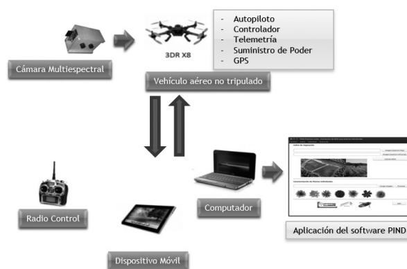
Figura 1. Arquitectura del sistema general para adquisición de imágenes multispectrales
